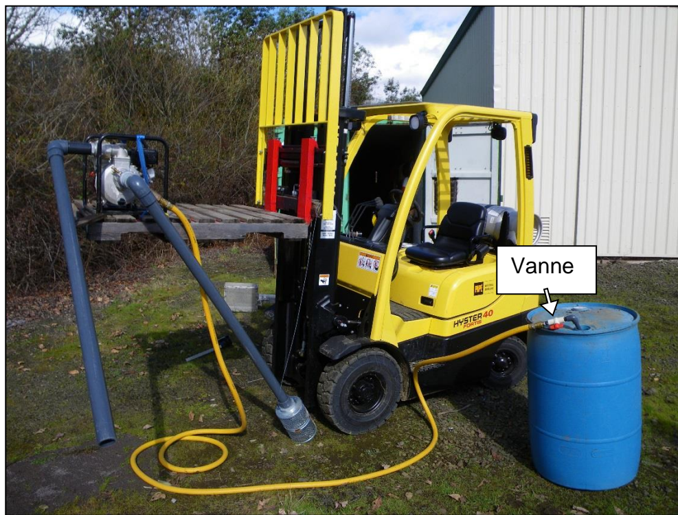
Figure 3.4. Exemple d'un système utilisé pour le traitement dans un lac (vue complète). Le bouchon de caoutchouc du tube n'apparaît pas sur cette image (Finlayson et coll., 2010).
