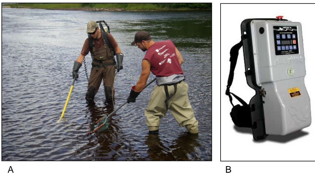
Figure 4.2. (A) Pêche à l'aide de l'unité portable à l'électricité (MFFP). (B) Unité portable à l'électricité (tiré du site www.smith-root.com ).
