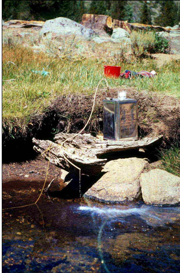
Figure 3.11. Réservoir-distributeur déversant la solution de roténone dans un cours d'eau. Bien que le produit soit répandu à la surface de l'eau sur l'image, il est préconisé de l'introduire sous la surface de l'eau (Finlayson et coll., 2010).
