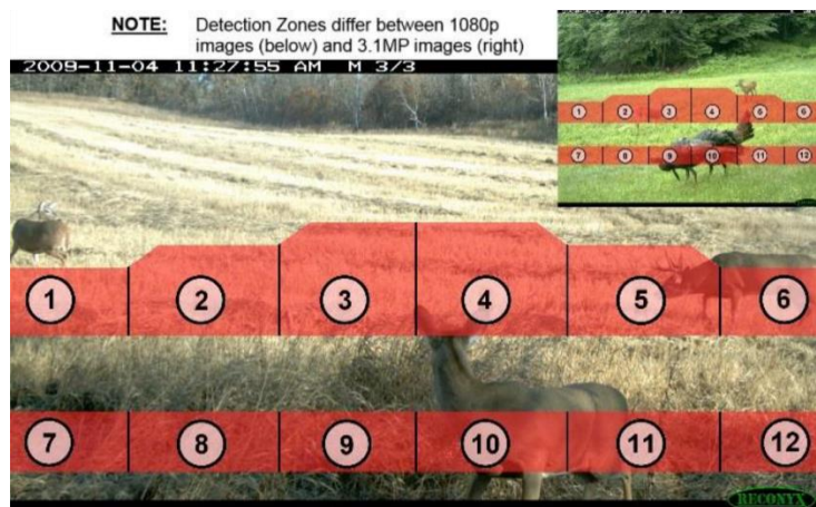
Figure B. Zones optimales pour le déclenchement par mouvement de la caméra
