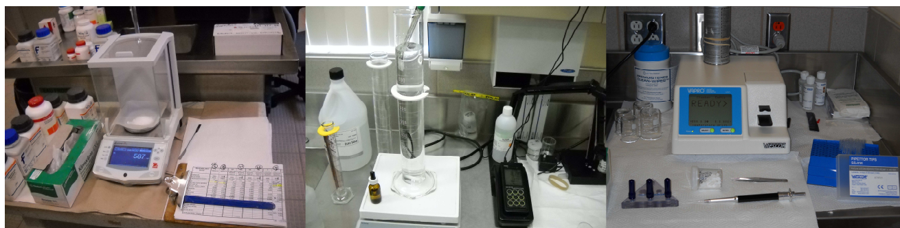
Figure 8. Appareils et matériel utilisés pour la conception et la fabrication des dilueurs. À gauche, une balance analytique et les différents produits chimiques qui composent un dilueur. Au centre, un agitateur magnétique, un cylindre gradué de 1 000 ml ainsi qu'un pH-mètre. À droite, un osmomètre Wescor® 5520 et son matériel consacré aux analyses de la pression osmotique.
