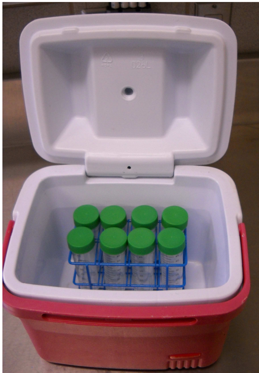
Figure 7. Le support est immergé dans une petite glacière isotherme qui contient un mélange composé en parts égales de glace et d'eau glacée.
