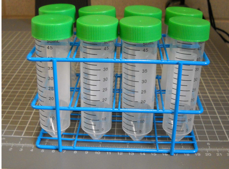
Figure 6. Ce support métallique contient huit tubes gradués de 50 ml pour centrifugeuse. Les tubes sont utilisés pour prélever et conserver la laitance à court terme.
