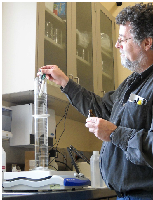
Figure 9. On utilise un titrage pour obtenir l'unité de pH souhaitée. L'électrode du pH-mètre et sa sonde de température sont à l'arrière-plan du compte-gouttes qui verse la solution de NaOH 0,5 N. On ajuste l'osmolalité de la solution à une valeur précise directement dans le cylindre gradué de 1 000 ml, en agitant légèrement et en ajoutant du NaCl ou de l'eau désionisée.
