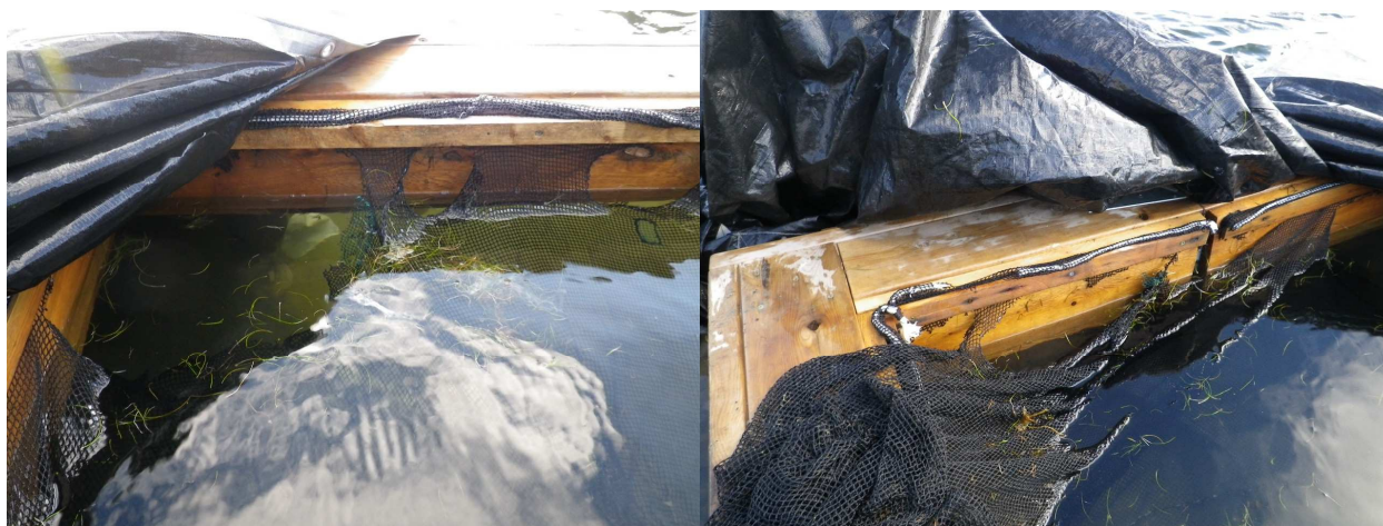
Figure 5. Le matériau synthétique de cet enclos a subi l'assaut de rats musqués, ce qui a entraîné la fuite de tous les reproducteurs en rétention.
