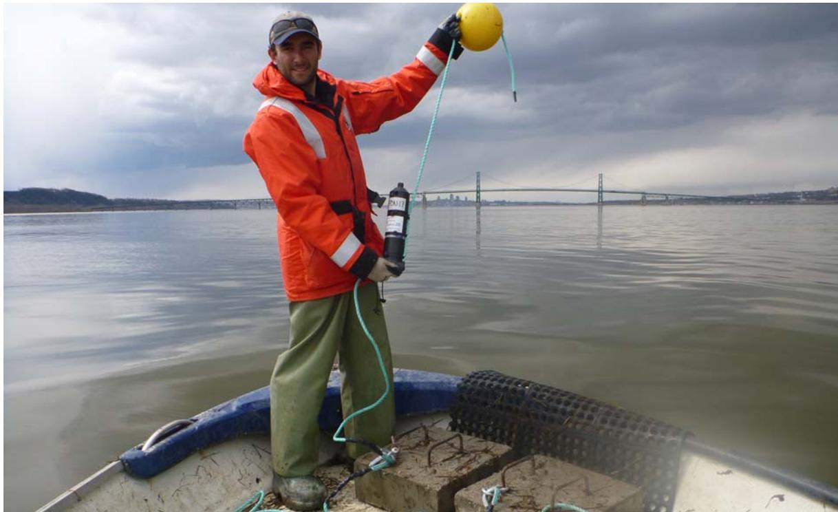
Figure 12 : Montage d'un récepteur hydroacoustique de type VR2W (VEMCO) avec bouée et poids.
