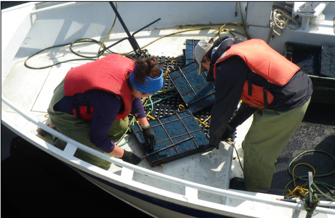
Figure 33 : Montage d'un capteur d'œufs de type filtre pour chaudière inséré dans un cadre métallique.
