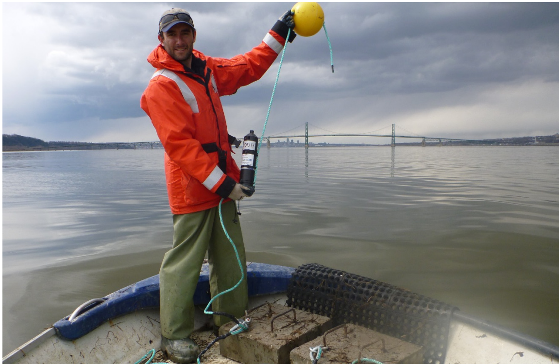
Figure 67 : Montage d'un récepteur hydroacoustique de type VR2W (VEMCO) avec bouée et poids.
