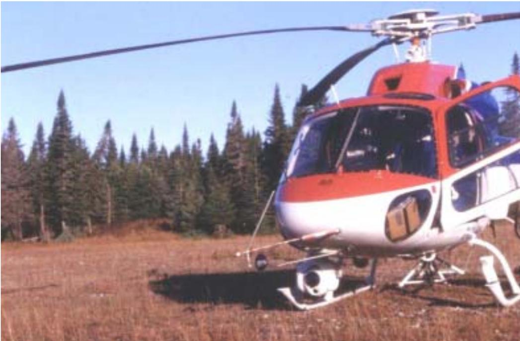
Figure 1. Illustration du FLIR monté sur un hélicoptère Astar Twin.
