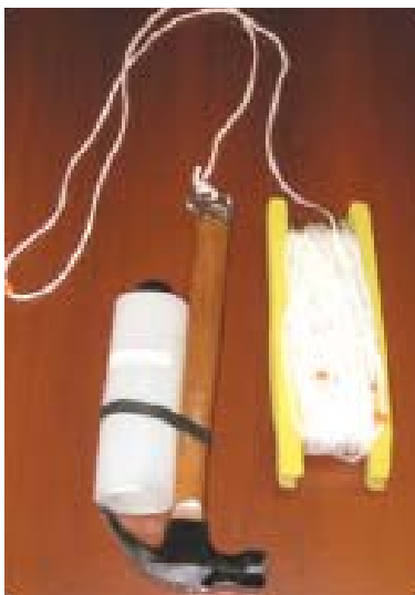
Figure 7. Porte-bouteille suggéré pour l'échantillonnage intégré du phosphore total. Tiré de MDDEP et CRE Laurentides (2009).
