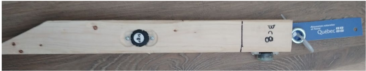
Figure 1 : Enregistreurs de données de température sans fil installés sur un piquet de bois. La ligne noire indique l'interface entre l'eau et le substrat.
