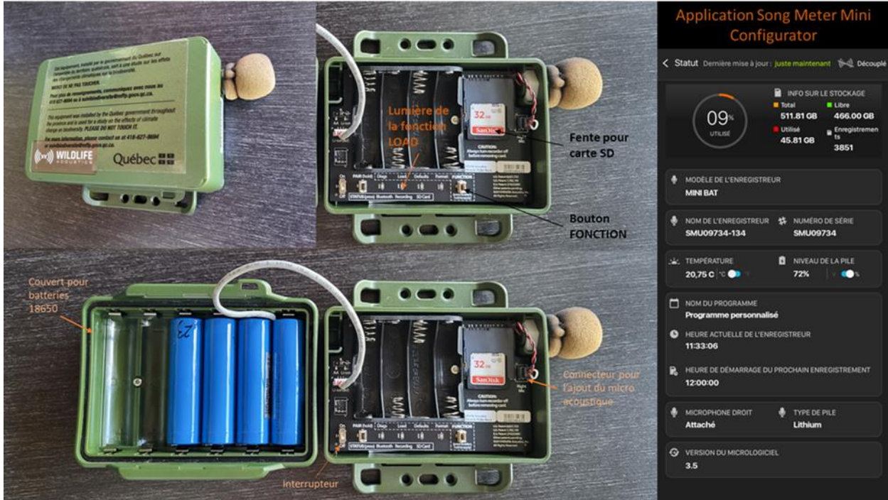
Figure A Appareil d'enregistrement SMMB de Wildlife Acoustics (à gauche) et fenêtre de statut de l'application Song Meter Mini Configurator (à droite) © MELCCFP
