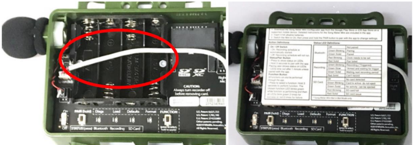
Figure B. Méthode pour placer le câble du couvercle ainsi que la plaque de métal © Wildlife Acoustics inc.
