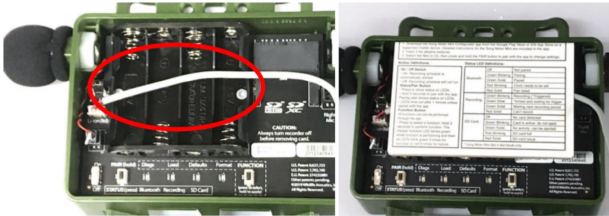
Figure 3. Méthode pour placer le câble du couvert ainsi que la plaque de métal © Wildlife Acoustics inc.
