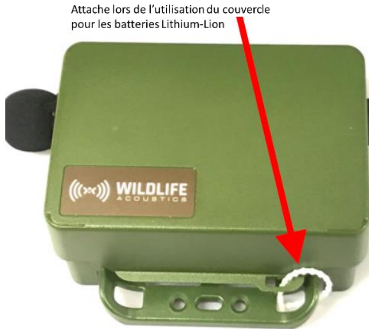
Figure 1. Appareil acoustique Song Meter Mini Bat avec attache qui relie le couvercle à l'appareil © Wildlife Acoustics inc.
