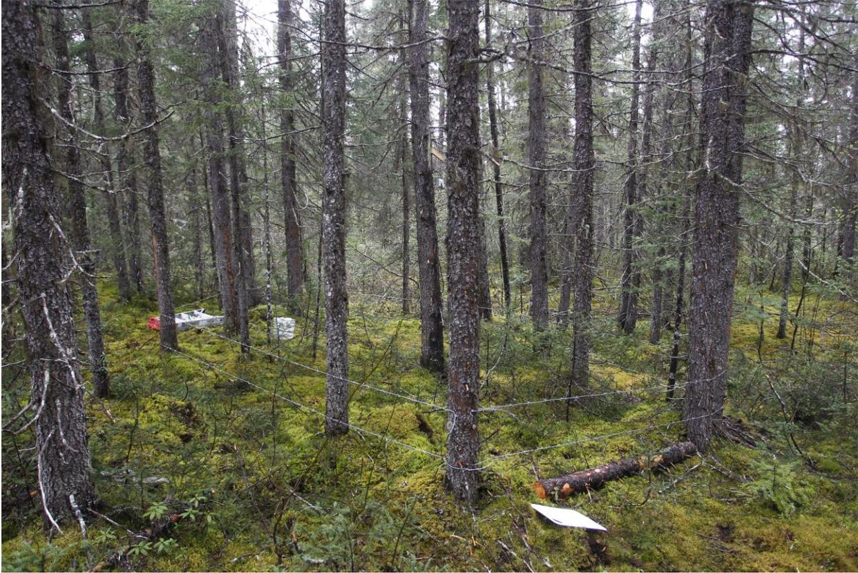
Station d'échantillonnage avec les arbres qui permettent de soutenir les fils barbelés installés à deux hauteurs différentes à partir du sol.
