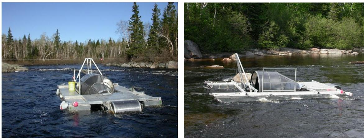
**Figure 6.2** Trappes rotatives utilisées pour la capture des saumoneaux à la rivière de la Trinité.
