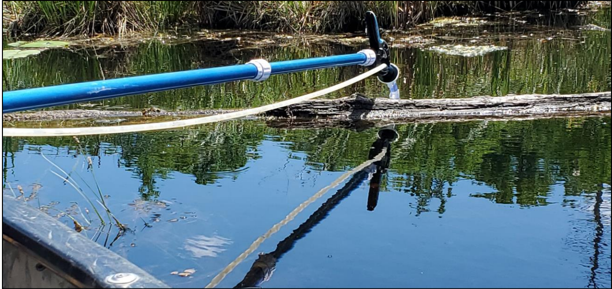
Figure 19. Dispositifs de pompage et de filtration installés directement sur la perche
