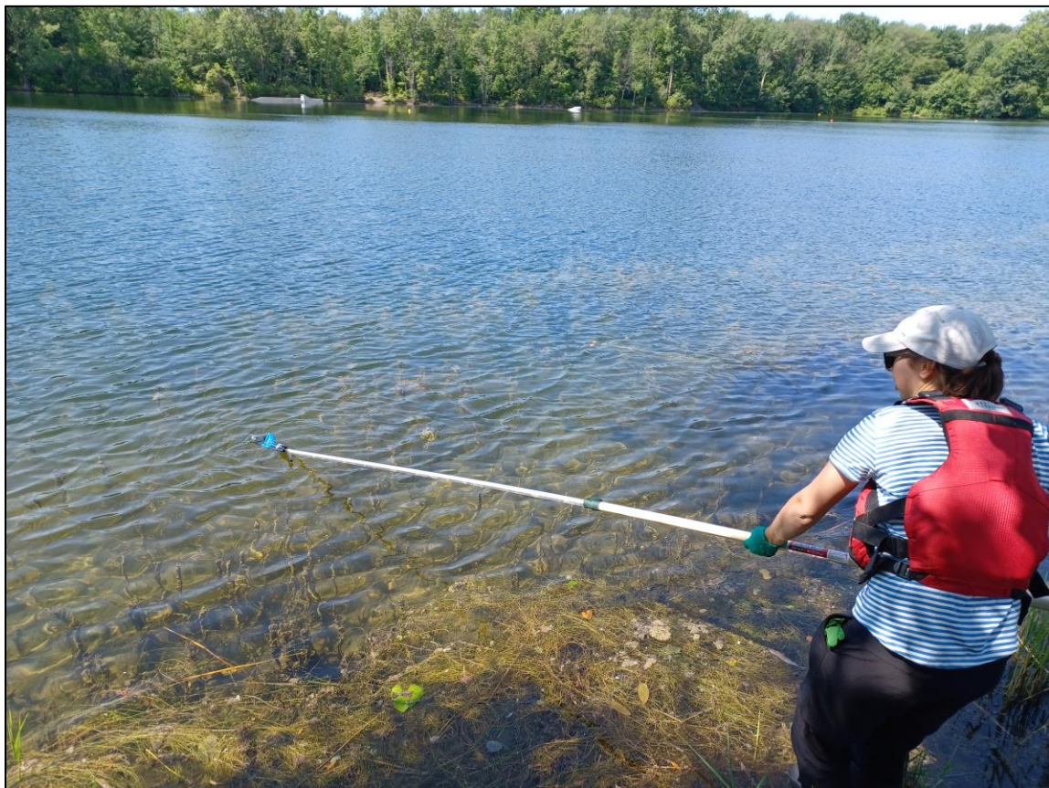
Figure 18. Échantillonnage de l'eau à l'aide d'une perche et d'une bouteille neuve ou stérilisée
