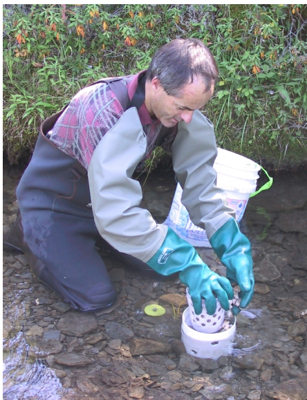
Le SÉDIBAC est facile à installer dans le substrat graveleux des cours d'eau.
