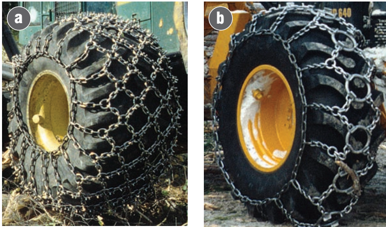
Figure 27a et b. Pneus munis de chaînes pour réduire le patinage. a) en losanges et b) en anneaux.
