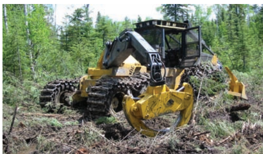
Figure 46. Débardeur équipé d'un grappin pivotant et d'essieux tandems arrière avec chenilles.
