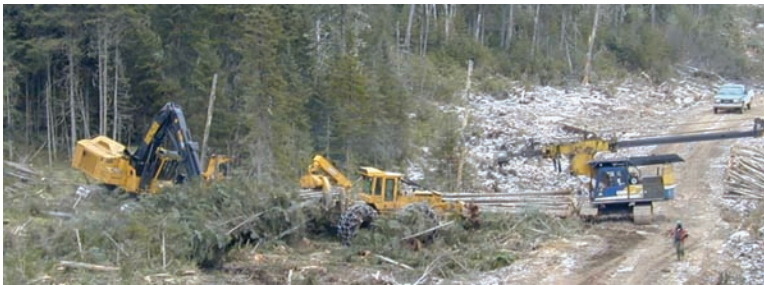
Figure 31. Système mécanisé par arbres entiers montrant une abatteuse-groupeuse, un débardeur à grappin et une ébrancheuse à flèche.
