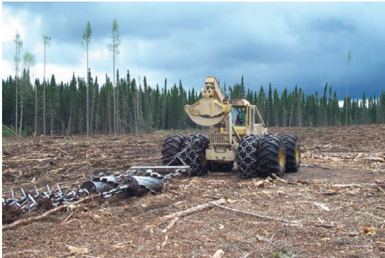
Figure 24. Utilisation de deux pneus pour une portance accrue.
