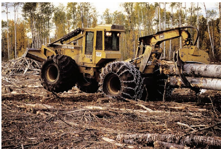
Figure 16. Débardeur surchargé dont les roues avant ne touchent pas le sol.
