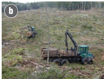
Figure 32a et b. Système par bois tronçonnés montrant une abatteuse-façonneuse (a) et un porteur (b).
