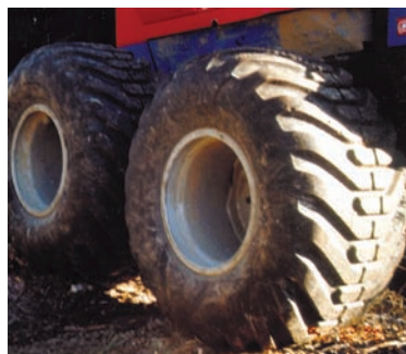
Figure 26. Des extrémités de barrettes arrondies réduisent la perturbation.
