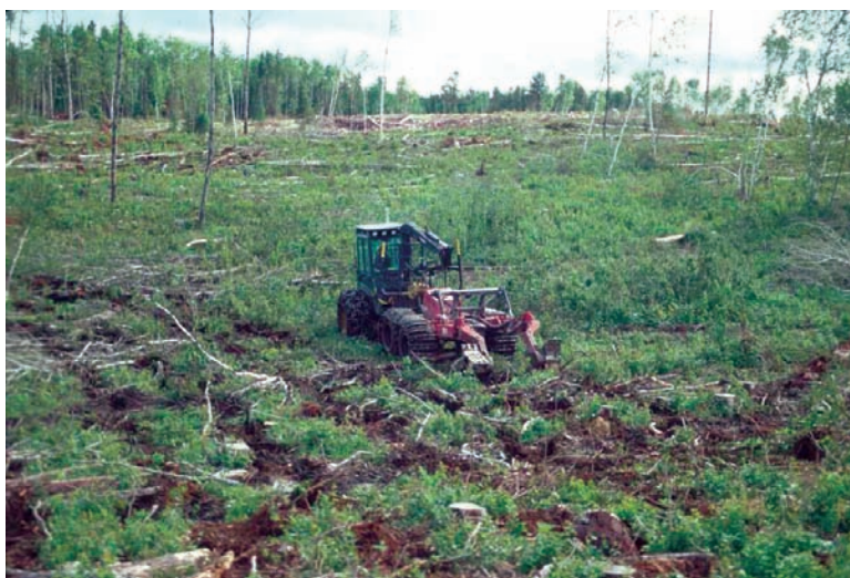
Figure 50. Préparation de terrain dans un terrain bas au milieu de l'été, lorsque le sol est plus sec.
