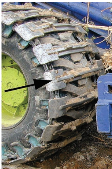
Figure 30. Les chenilles munies de plaques larges et arrondies (la flèche indique la plaque) font moins de dommages aux couches de sol superficielles.
