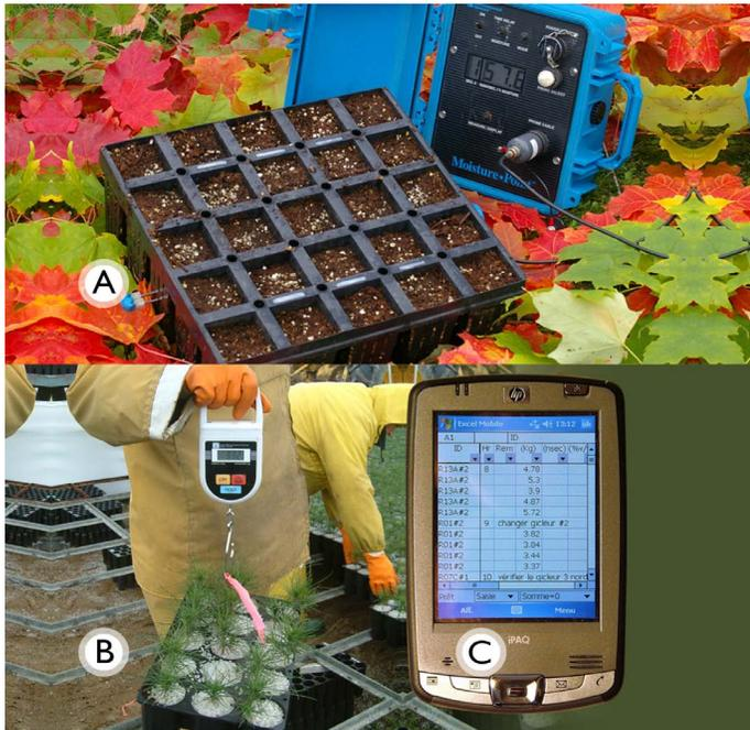
Figure 1. La teneur en eau volumétrique du substrat est calculée par IRREC à partir : (A) des mesures prises à l'aide d'un appareil MP-917, ou (B) de la masse des récipients mesurée avec une balance numérique. Ces données peuvent être saisies sur le terrain avec un ordinateur de poche grâce à « IRREC mobile » (C).
