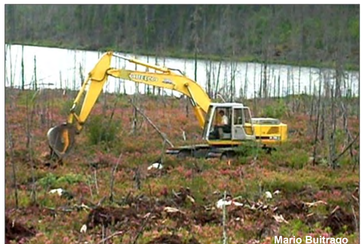
Les traitements en buttes et en inversions ont été réalisés à l'aide d'une pelle excavatrice.
