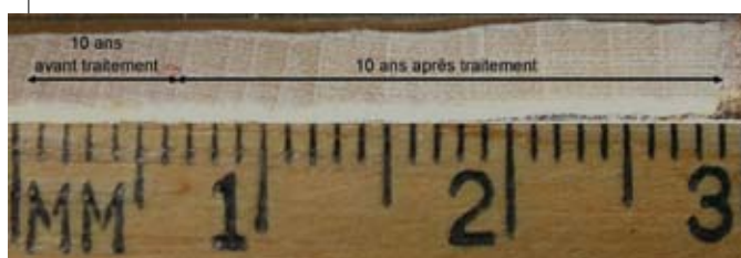
Figure 4. Carotte de bois montrant l'effet du chaulage, réalisé en 1994, sur la croissance radiale d'un érable à sucre (à droite du point rouge) ayant reçu une dose de chaux de deux tonnes à l'hectare. L'année du chaulage est indiquée par un point rouge.
