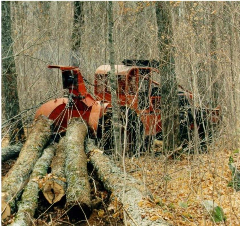
Figure 16. Le débardage des tiges se fait à l'aide de débusqueuse à câble. Les tiges sont souvent tronçonnées avant débardage afin de minimiser les blessures aux arbres résiduels.
