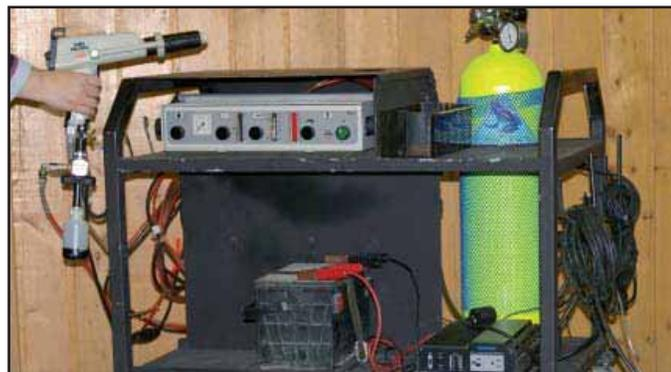
Photo 8. Chariot conçu pour le déplacement du pistolet électrostatique et du matériel qui l'accompagne (bouteille d'air comprimé, alimentation électrique, redresseur de courant et filtre à air) (photo Fabienne Colas).
