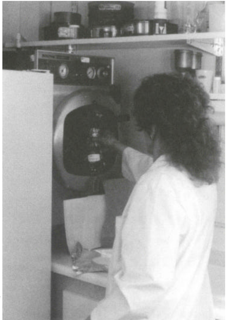
Figure 19. Stérilisation en autoclave des milieux de culture et des instruments servant à l'ensemencement des boîtes de Pétri.
