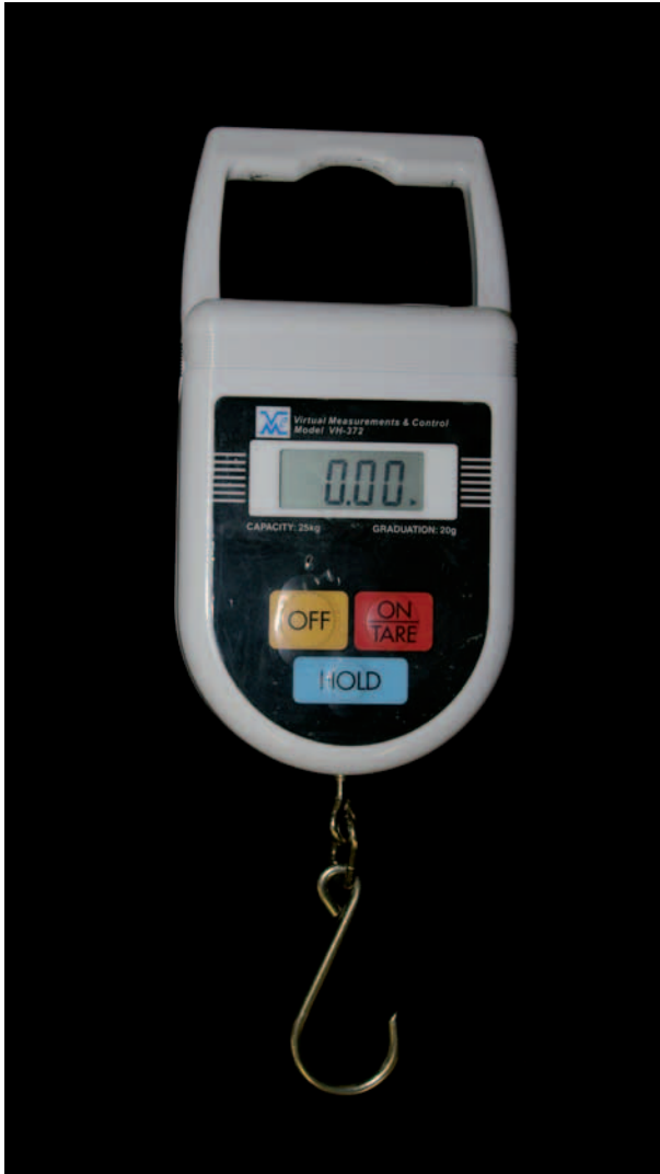
Figure 3. Exemple de peson numérique pouvant servir à mesurer la teneur en eau du substrat par gravimétrie dans les productions à grande échelle. La mesure obtenue implique de pouvoir estimer la masse fraîche des plants au moment de la pesée et aussi, de connaître les masses des composantes autres que l'eau (récipient, tourbe sèche, silice, etc.). (Photo : D. Girard).
