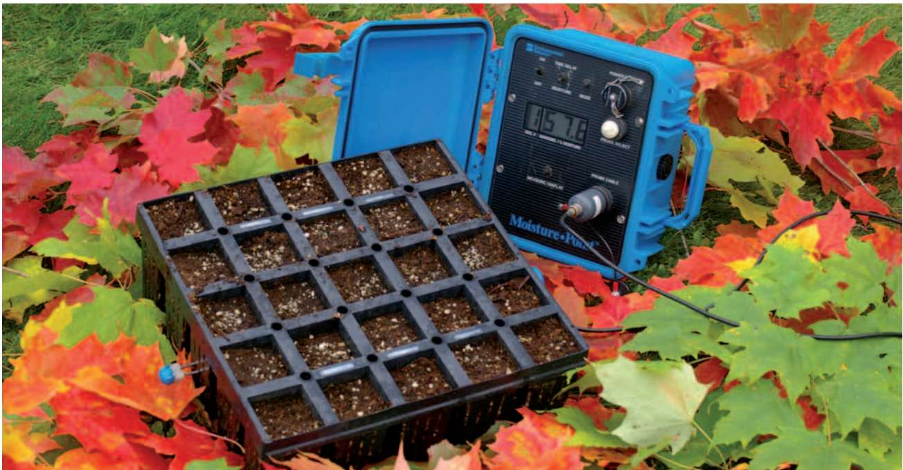
Figure 2. Appareil portable ( MP-917 ) de mesure de la teneur en eau volumétrique du substrat (% , v/v) par réflectométrie dans le domaine temporel (RDT). La mesure obtenue ne dépend de rien d'autre que de la teneur en eau du substrat. (Photo : M. Renaud).
