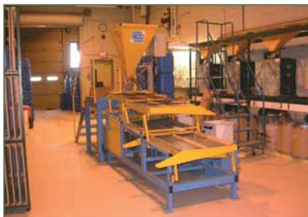
Figure 1 : Crible BCC utilisé au CSFB pour la réalisation de la séparation des graines par grosseur. Photo M. Bettez.
