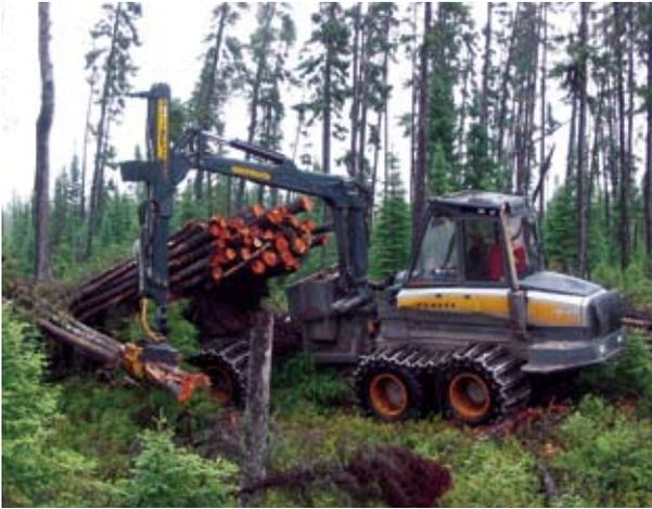
**Figure 13.** Semi-porteur d'une capacité de 14 tonnes au chargement.
