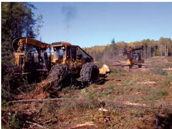
**Figure 11.** Débardeur à grappin approchant d'une jetée d'ébranchage.
