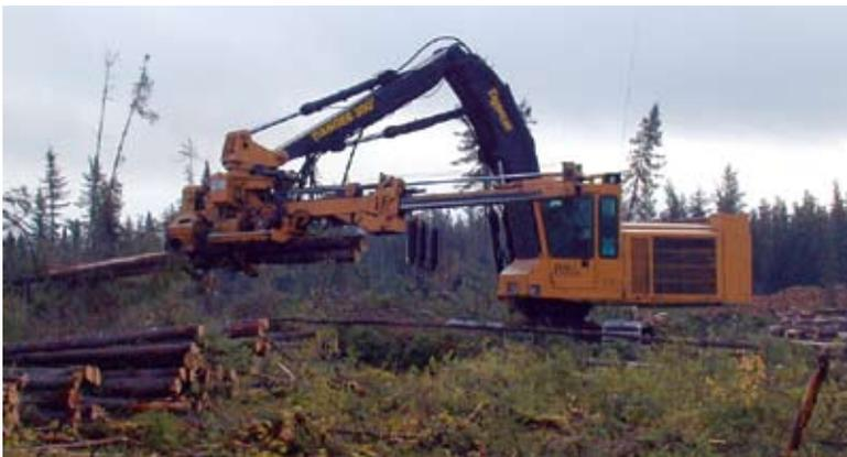
**Figure 19.** Façonneuse travaillant sur des arbres déjà abattus.
