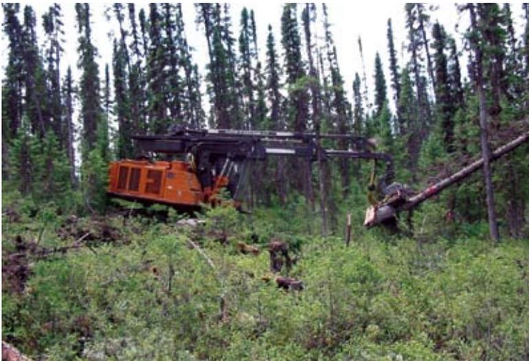
**Figure 14.** Abatteuse-façonneuse à flèche télescopique.
