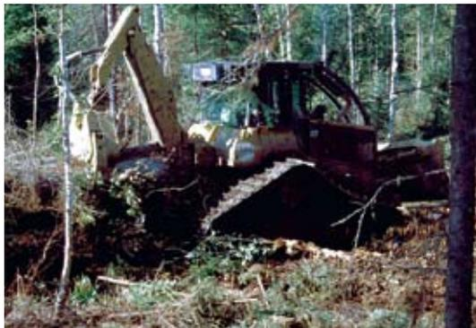
**Figure 26.** Débardeur chenillé muni d'un grappin sur flèche pivotante.
