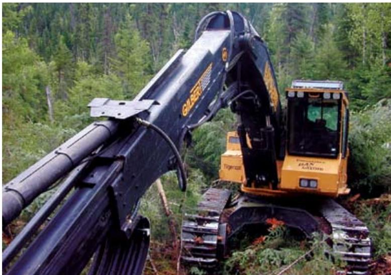
d'une plus grande distance, sans que l'abatteuse n'ait à se déplacer. Ce faisant, on doit toutefois éviter de faucher la haute régénération. Dans le cas d'extraction par un débardeur à grappin, on doit viser à former des piles correspondant à la capacité de chargement et de transport de la machine.
