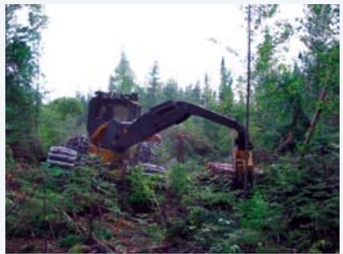
**Figure 12.** Débardeur à grappin monté sur flèche pivotante au chargement. (Le modèle illustré est à 6 roues motrices et les bogies arrière sont munis de chenilles.)
