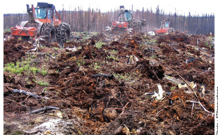
Le scarifiage à disques crée des sillons le long desquels les plants sont mis en terre.
