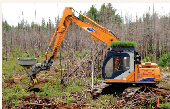
La planteuse mécanique P11a de Bracke fait un scarifiage par monticule avant la mise en terre.
