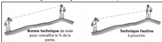
Figure 50 Mesurage de l'inclinaison de la pente
