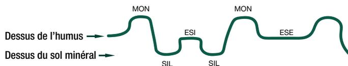
Figure 1. Représentation schématique des types de microsites échantillonnés. ESI = entre sillons, ESE = entre sentiers, SIL = sillon, MON = monticule.
