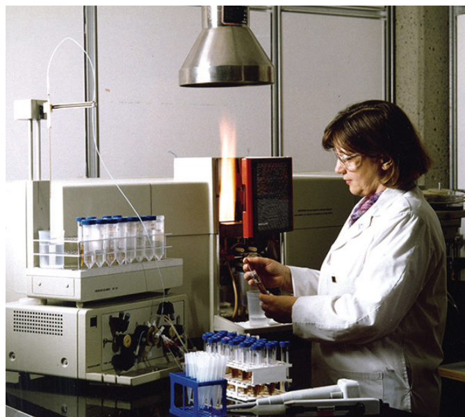
Une technicienne de laboratoire faisant l'analyse des métaux présents dans les sols par spectrométrie d'absorption atomique. MER 1997 Marc-André Grenier.
