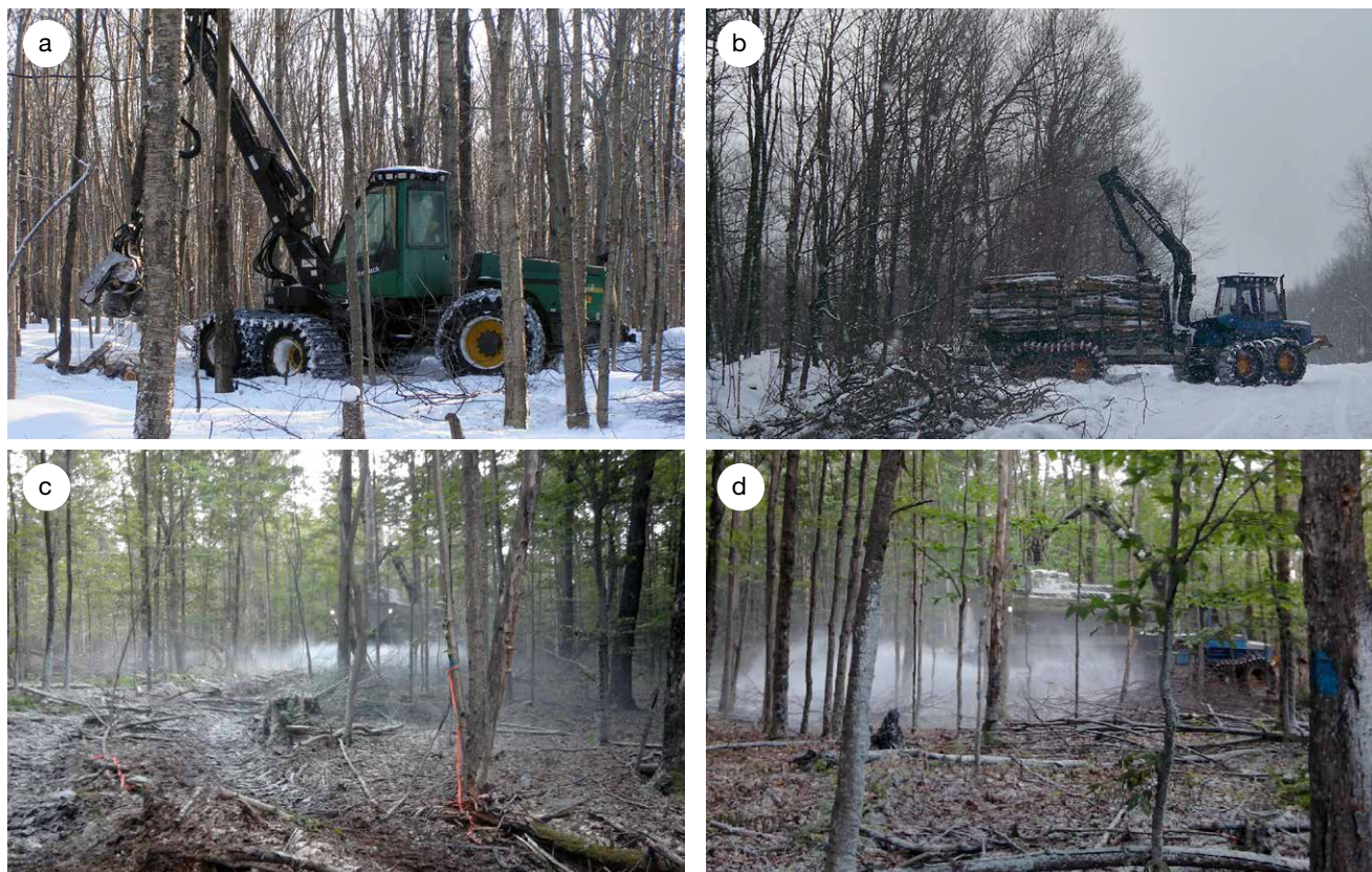
Figure 3. Équipements utilisés : a) abatteuse multifonctionnelle pour la récolte; b) porteur forestier pour le débardage; c) et d) porteur forestier avec épandeur pour l'amendement du sol (Photos : Domtar).
