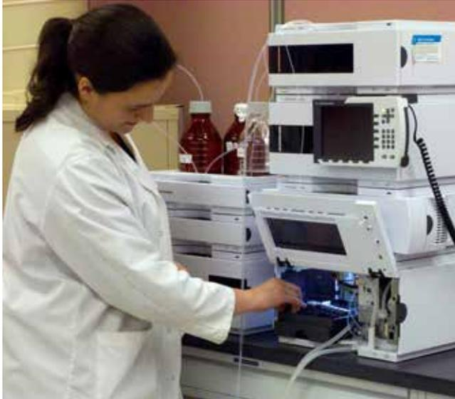
Détermination des sucres dans les tissus végétaux par chromatographie en phase liquide à haute performance. Karyne Morin, technicienne de laboratoire (Photo : B. Boudreault).
