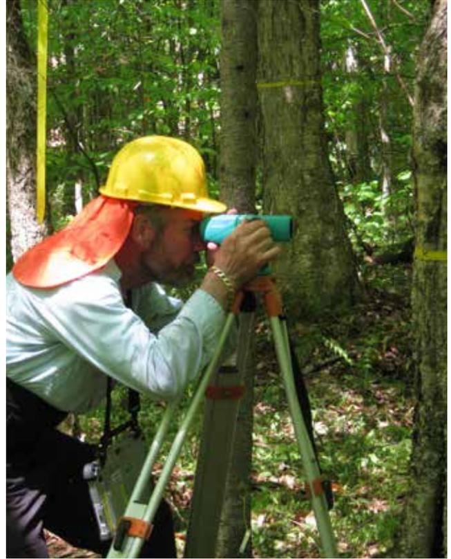
Mesure de la pente d'une placette-échantillon avec un niveau optique (Photo : H. Power, MFFP).
