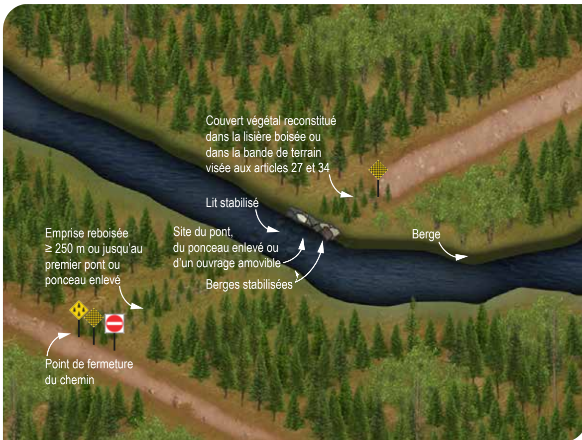
Figure 81 Travaux à exécuter lors de la fermeture permanente d'un chemin
