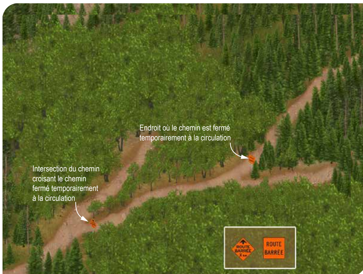
Figure 115C Signalisation indiquant la fermeture temporaire d'un chemin
