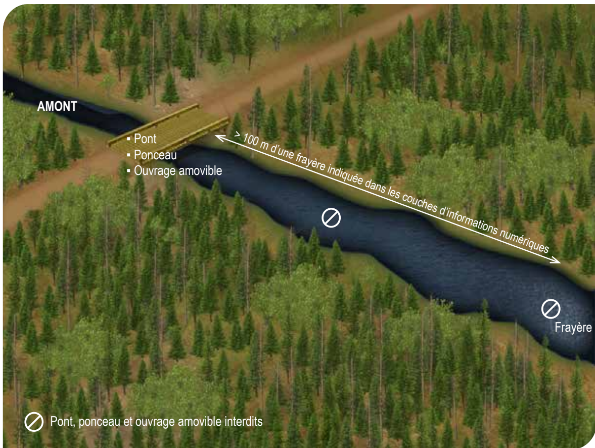
Figure 89 Distance à respecter entre une frayère et un pont, un ponceau ou un ouvrage amovible
