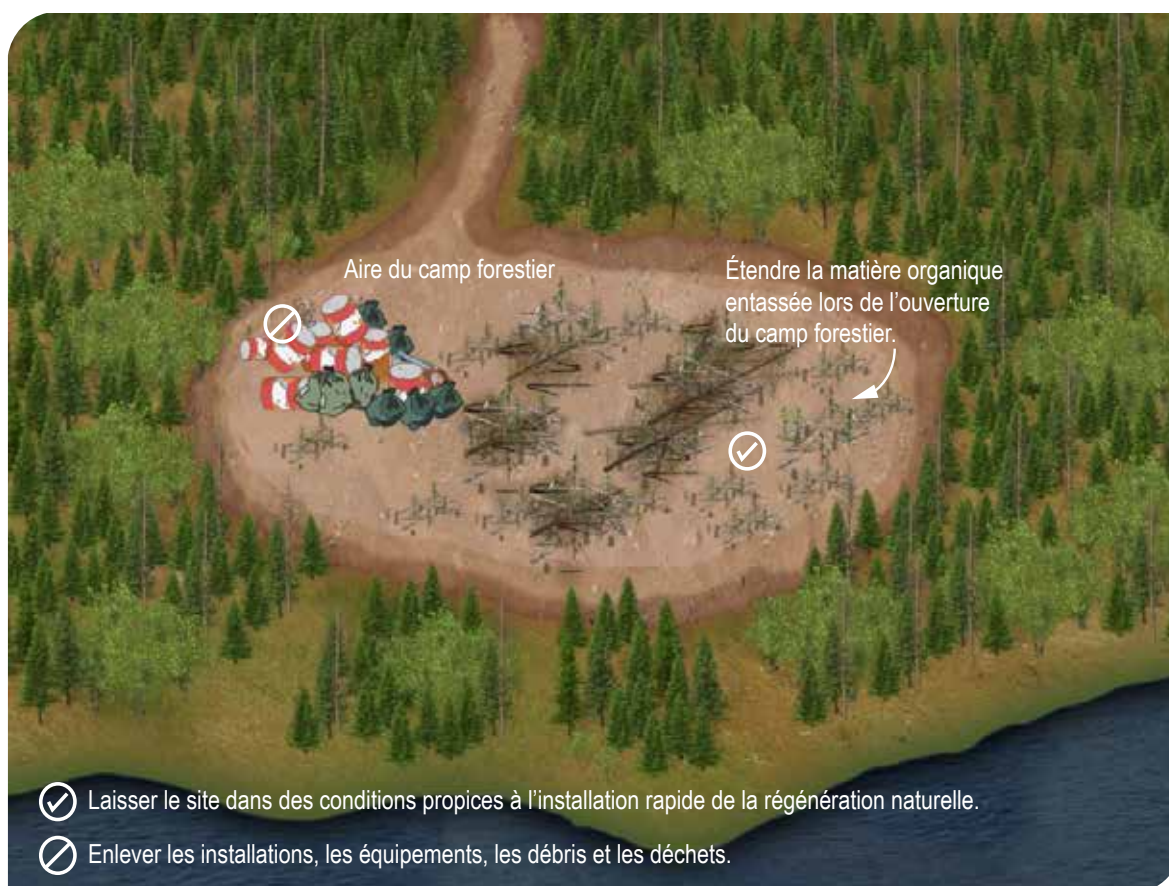
Figure 129 Restauration de l'aire d'un camp forestier à la fin de son utilisation
