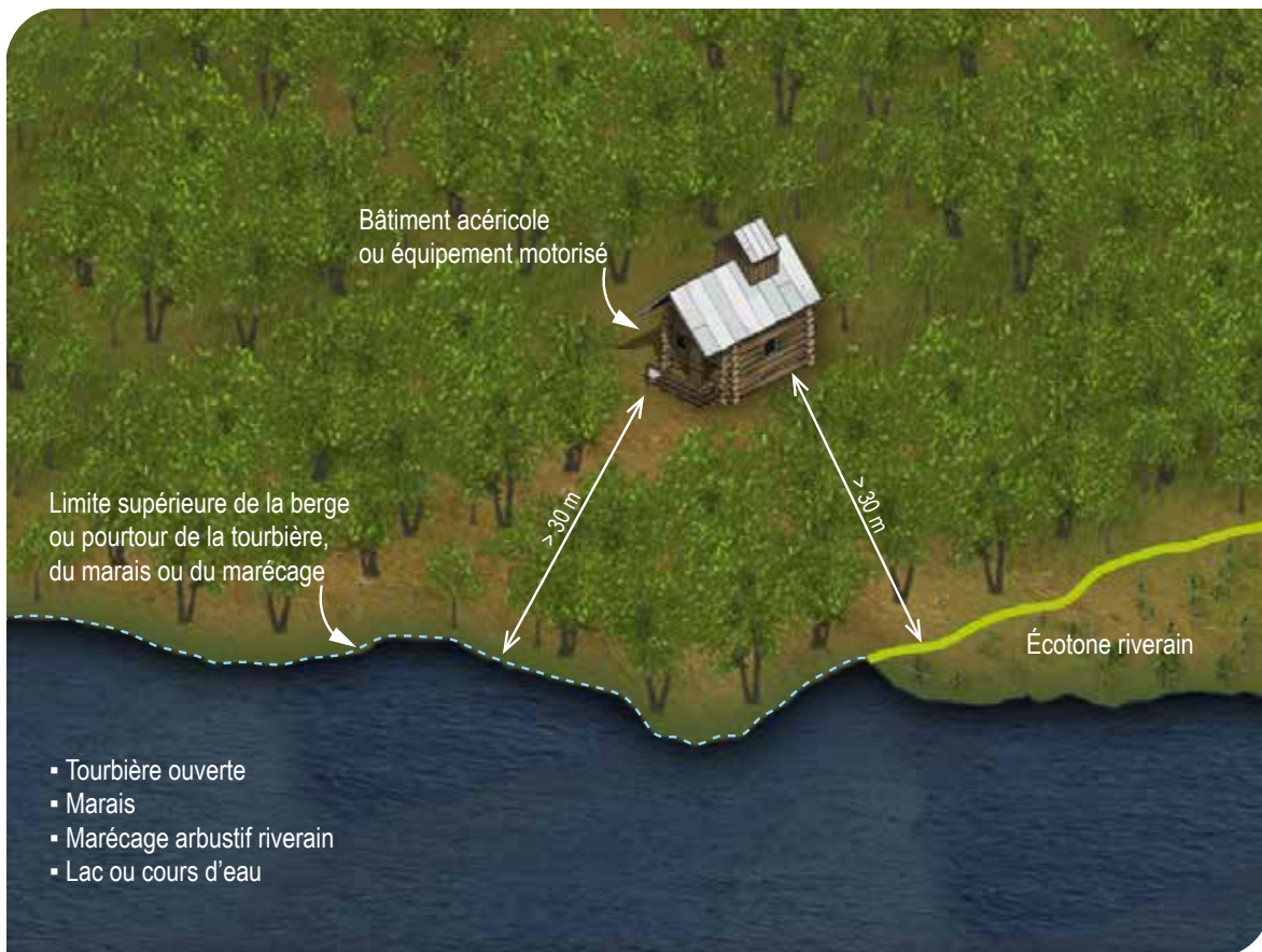
Figure 130 Distance à respecter entre un bâtiment acéricole, ou l'équipement motorisé nécessaire à l'exploitation d'une érablière acéricole, et un milieu humide ou aquatique
