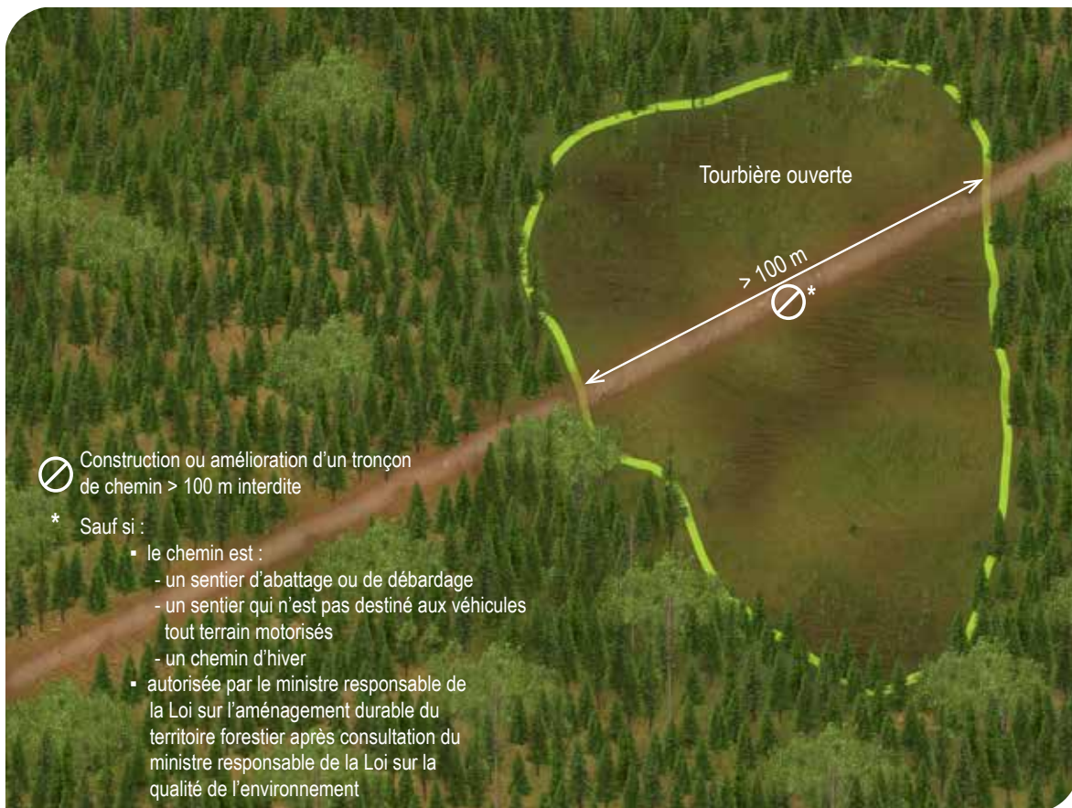
Figure 70 Règles qui régissent la construction ou l'amélioration d'un chemin situé dans une tourbière ouverte
