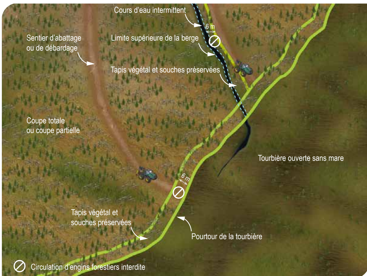
Figure 34A Règles qui régissent la circulation d'un engin forestier en bordure d'un milieu humide ou aquatique
