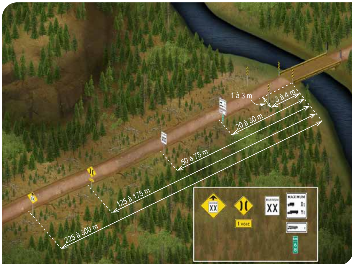
Figure 117 Signalisation aux abords d'un pont
