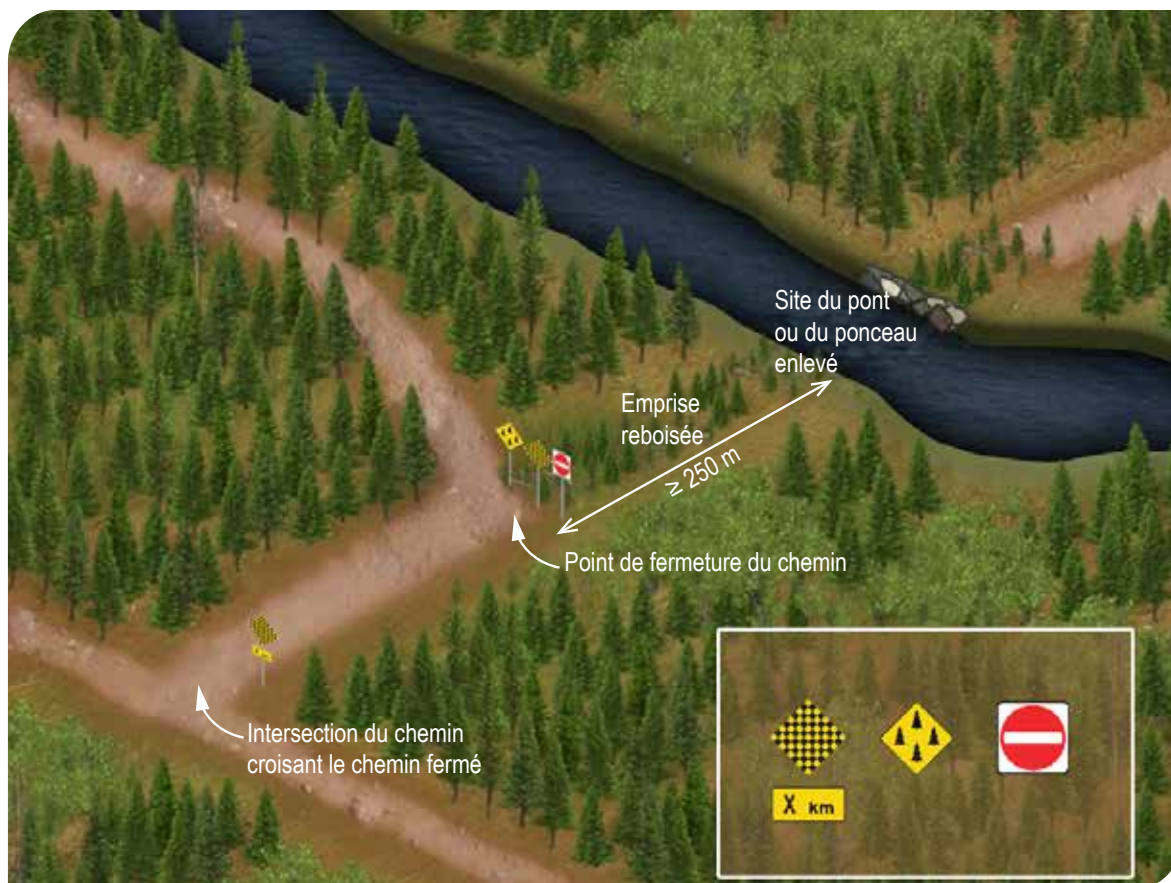
Figure 115B Signalisation indiquant la fermeture permanente d'un chemin
